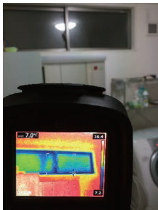
サーモグラフィを使えば家の弱点が一目瞭然。(築10年) 内窓を取り付ける提案をします。
